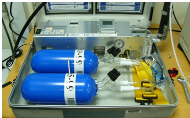
▲ NOAA 提供溫室氣體採樣器，監測重要溫室氣體。
