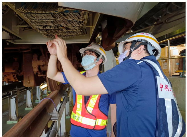
▲號誌系統車載設備檢視作業。(左)
